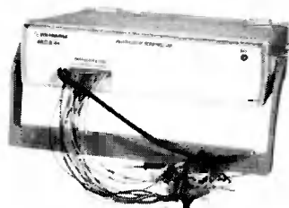
Рис. 4. Логический анализатор АКС-3166
